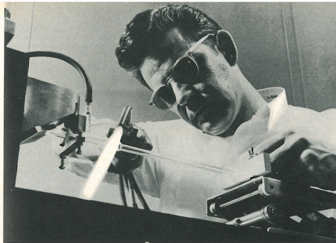
Nella fotografia qui sopra viene mostrata una fase di saldatura delle parti in vetro di un laser a gas.
